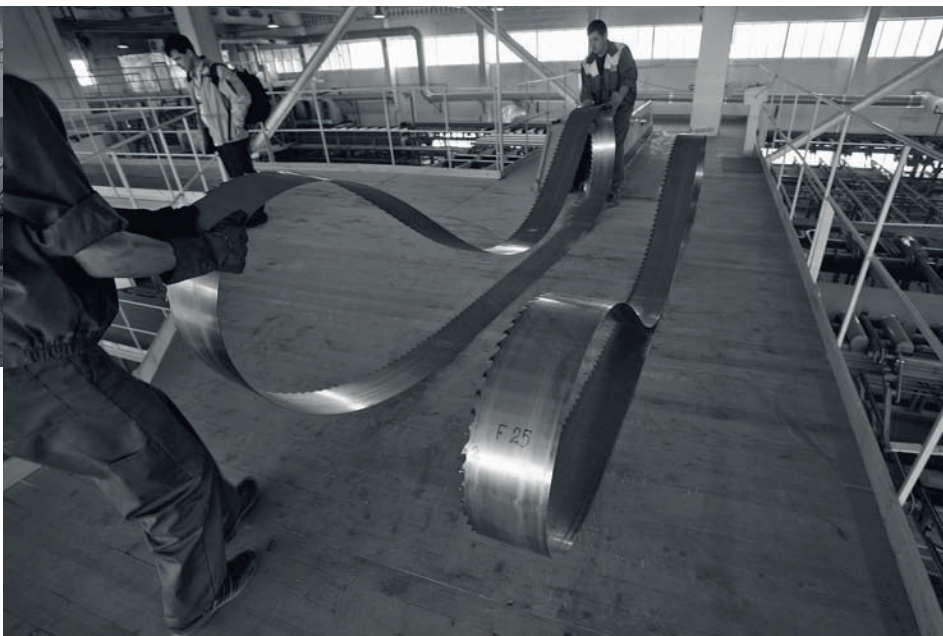
Требования к заточке пил для распиловки березы куда выше, чем при обработке сосны
