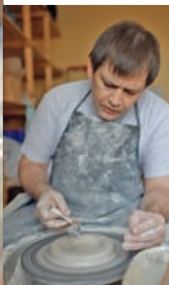
Чтобы сделать стенки тоньше, Хейнсворт растягивает края вверх. Плошка превращается в цилиндр
