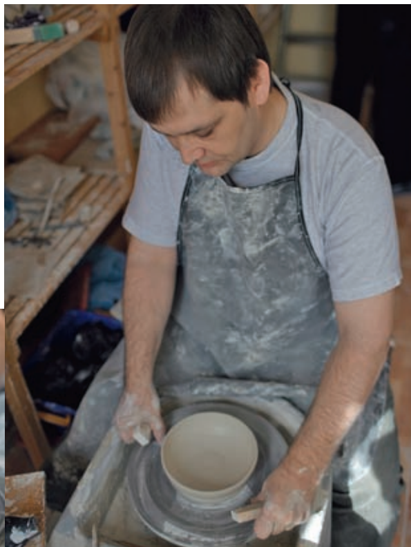
Готовая плошка срезается с гончарного круга с помощью нитки, натянутой между двух брусков
